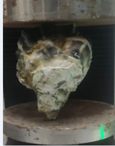
图7 牡蛎壳长方向压缩试验实物图
