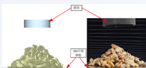
图7 贝苗堆积角验证试验
