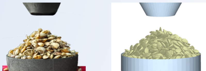
图6 贝苗堆积角验证试验
