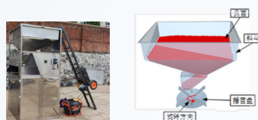
图8 播苗装置验证试验
