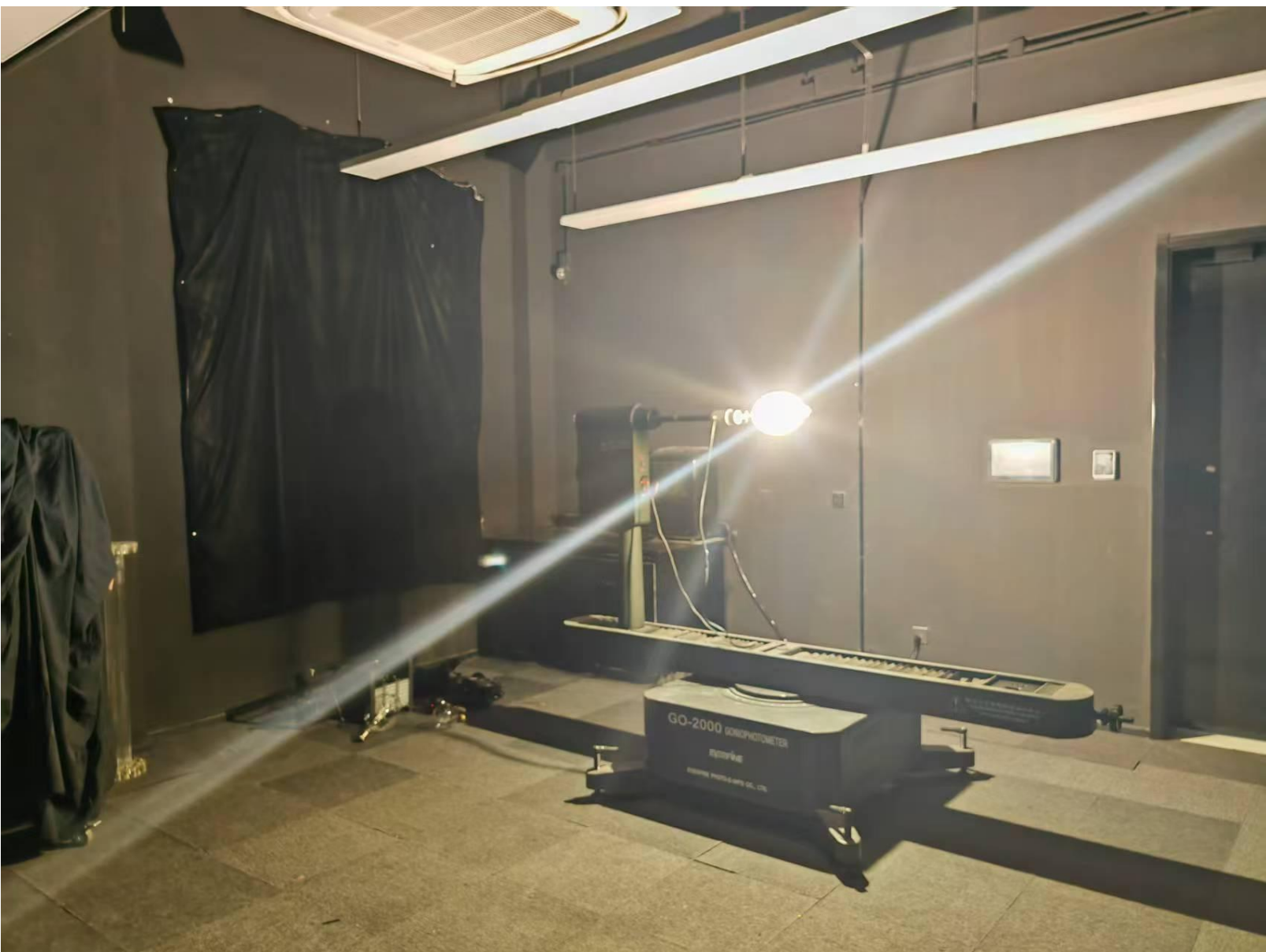
图2 集鱼灯光学性能测试
